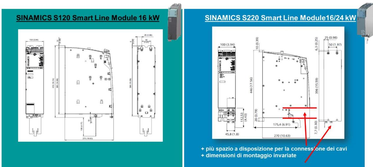
Anche il supporto dello schermo e lo scarico della trazione del cavo sono stati migliorati.
